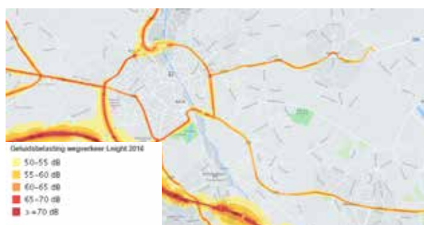
Figuur 50. Geluidsbelasting wegverkeer Lnight bron: Geopunt Vlaanderen
