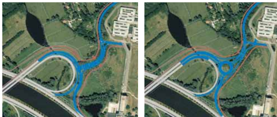
T-aansluiting met verkeerslichten of rondpunt
