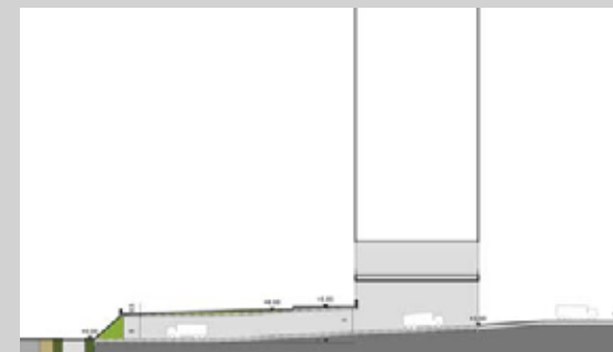
figuur | variant 1, tunnel onder C 3 snede
