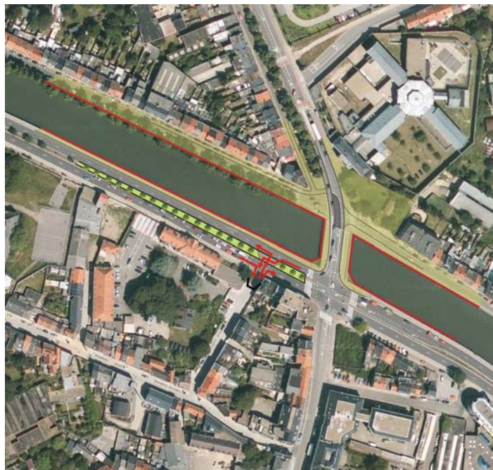
Voorstel beveiligen kruispunt Keldermansvest – Liersesteenweg - Frans Halsvest met middenberm: kruispunt onderdeel van plein
